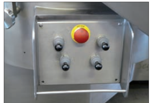
Bild 4: Die Kreuztaster an den Bedientableaus schaffen eine Voraussetzung für das intuitive Bedienen der Maschinen
